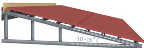
Hình A.3.2-Mái lợp điển hình, độ dốc mái 10°-15° (17%-27%)
