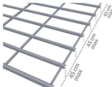
Hình A.3.2-Mái lợp điển hình, độ dốc mái 10°-15° (17%-27%)
